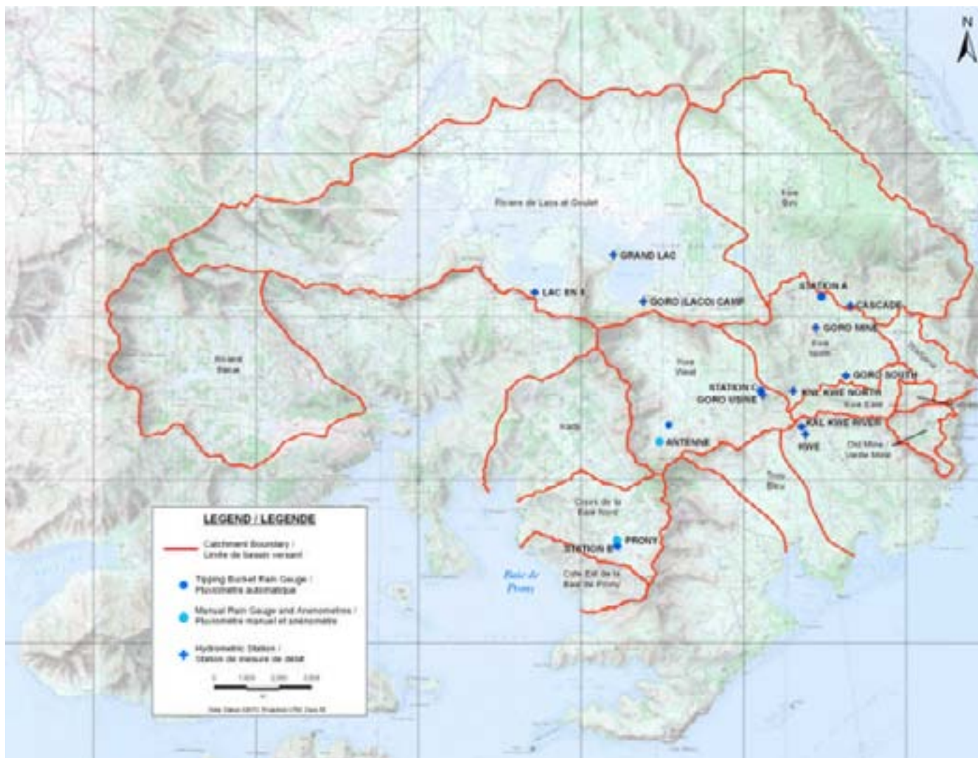
Figure 3 – Pluviomètres installés par Goro / Rainfall Gauges Established by Goro
