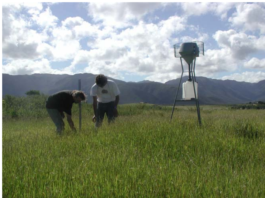
Figure 2. : Collecteur de précipitations de type jauge Hibernia
