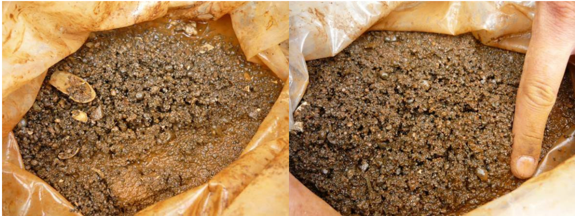
Figure 36 : Graves silteuses ou graves peu argileuses qui représentés par les échantillons KWE1-M, KWE2-M, KWE7-M, R1, R4 et R6.
