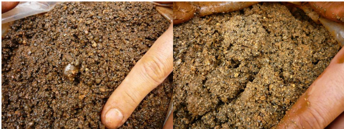
Figure 37 : Sables silteux ou peu argileux représentés par les échantillons KWE8-M, KWE11-M, KWE12-M, KWE15-M, KWE16-M, KWE18-M, KWE19-M, KWE20-M, R3 et R5.
