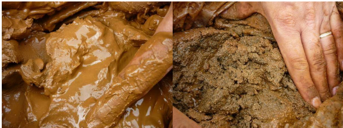
Figure 38 : Sables et graves très silteux ou argileux à très argileux représentés par les échantillons KWE3-M, KWE6-M, KWE10-M, KWE14-M, K7 et R2.
