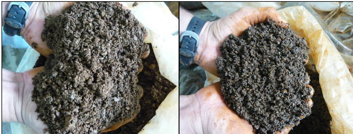
Figure 9 : Graves silteuses ou graves peu argileuses qui représentent les échantillons KWE-02-R, KWE-03-R, KWE-04-R, KWE-05-R, KWE-06-R, KWE-07-R, KWE-08-R, KWE-09-R, KWE-10-R, KWE-11-R, KWE-12-R, KWE-13-R, KWE-15-R, KWE-16-R, KWE-17-R, KWE-18-R, KWE-21-R, KWE-22-R, KWE-24-R et KWE-25-R.
