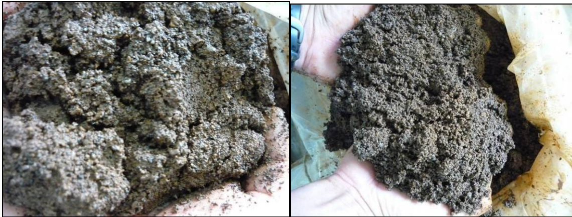
Figure 8 : Sables silteux ou peu argileux représentatifs des échantillons KWE-01-R, KWE-08-R, KWE-14-R, KWE-19-R, KWE-20-R et KWE-23-R
