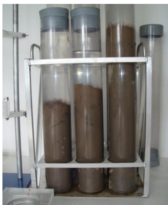
Figure 30 : Carottes extraites de la baie du Prony pour l'étude de la géochronologie et le calcul des taux de sédimentation.
