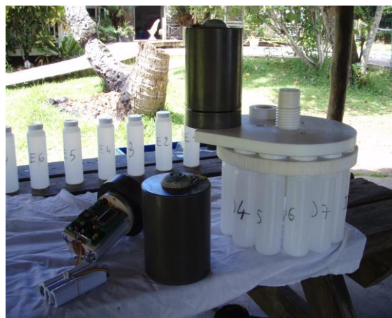
Figure 18 : Pièges à sédiments séquentiels et dispositif de collecte automatisé pour l'étude temporelle des flux de particules.
