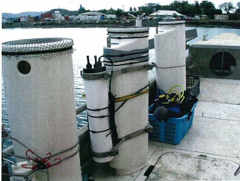
**Figure 4** : Pièges à sédiments déployés en Rade Nord, Rade Nord-Est et Baie Kwé pour la détermination des flux de matières minérale et terrigène exportées.
