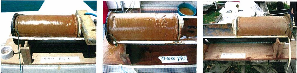
**Figure 3 :** Carottes sédimentaires PR-1, PR-2 et KW-1 extraites du carottier pour le découpage en tranches bi-centimétrique à des fins de datation par la méthode du  $^{210}\text{Pb}$ .
