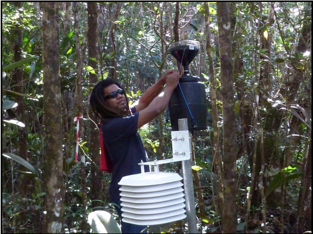
Figure 6: Pose de jauge Owen et de station météo au premier plan
