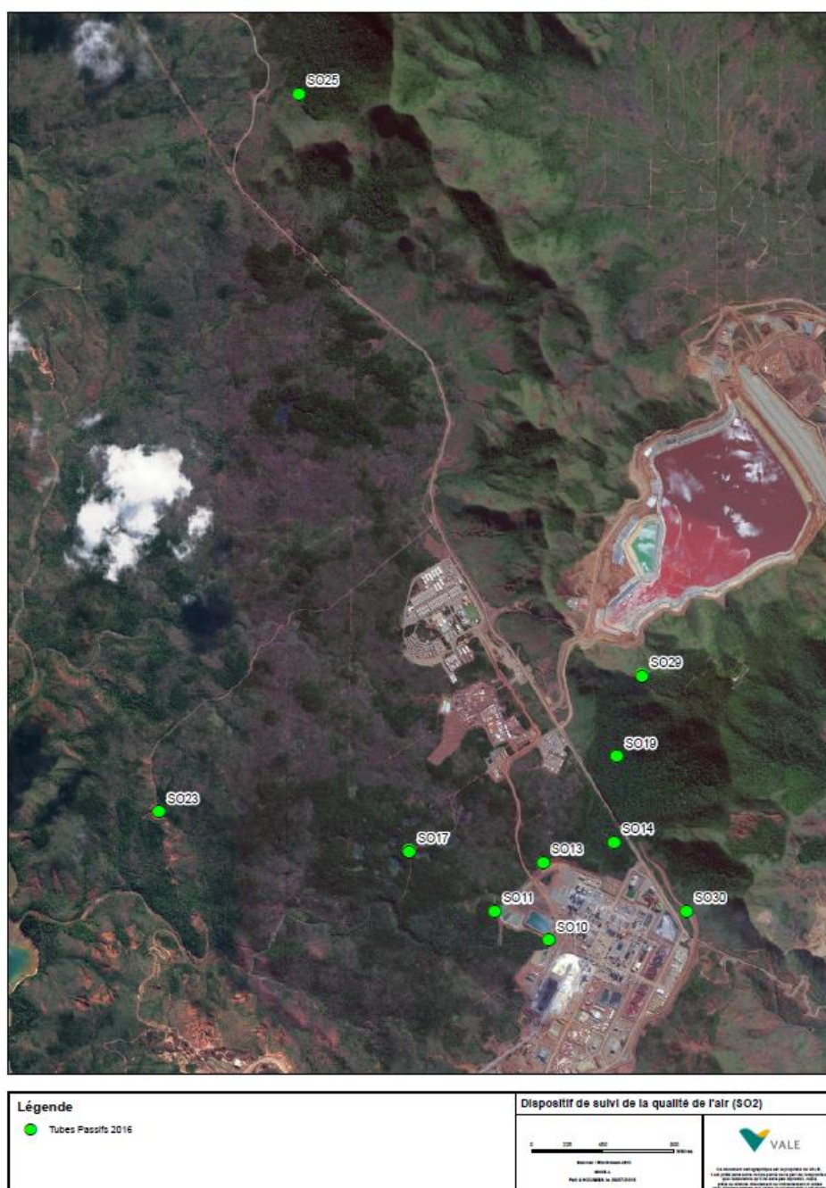
Figure 4 : Dispositif de suivi de la teneur mensuelle en SO 2 de l'air par tube passif.
