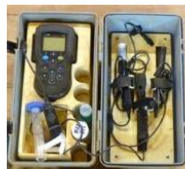
Planche photo 1: Sonde multiparamétrique Hach HQ40D.
