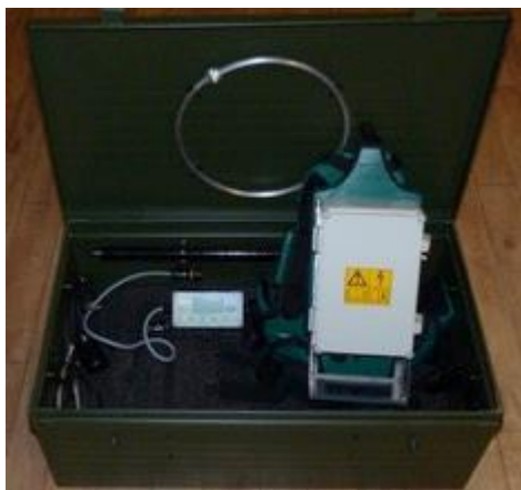
Planche photo 2: Appareil portatif de pêche électrique de la marque Imeo, modèle Volta.
