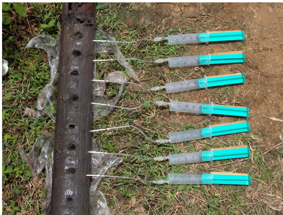
Photo 2 : Extraction d'eau interstitielle par la méthode des Rhizons®. Ces derniers sont connectés à des seringues dans lesquelles on crée une dépression.
