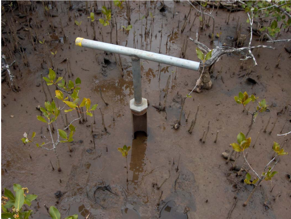
Photo 1 : Introduction de la tarière gouge dans le sédiment
