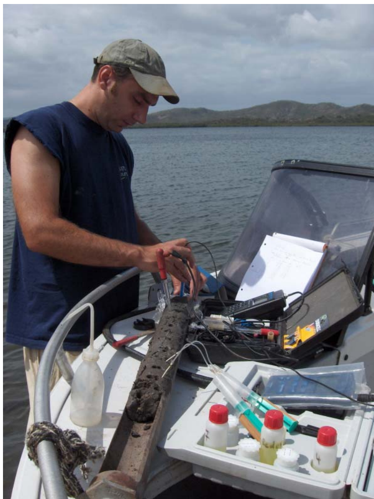
Photo 3 : Mesure des paramètres physico-chimiques par introduction directe des électrodes dans la carotte dès son prélèvement.
