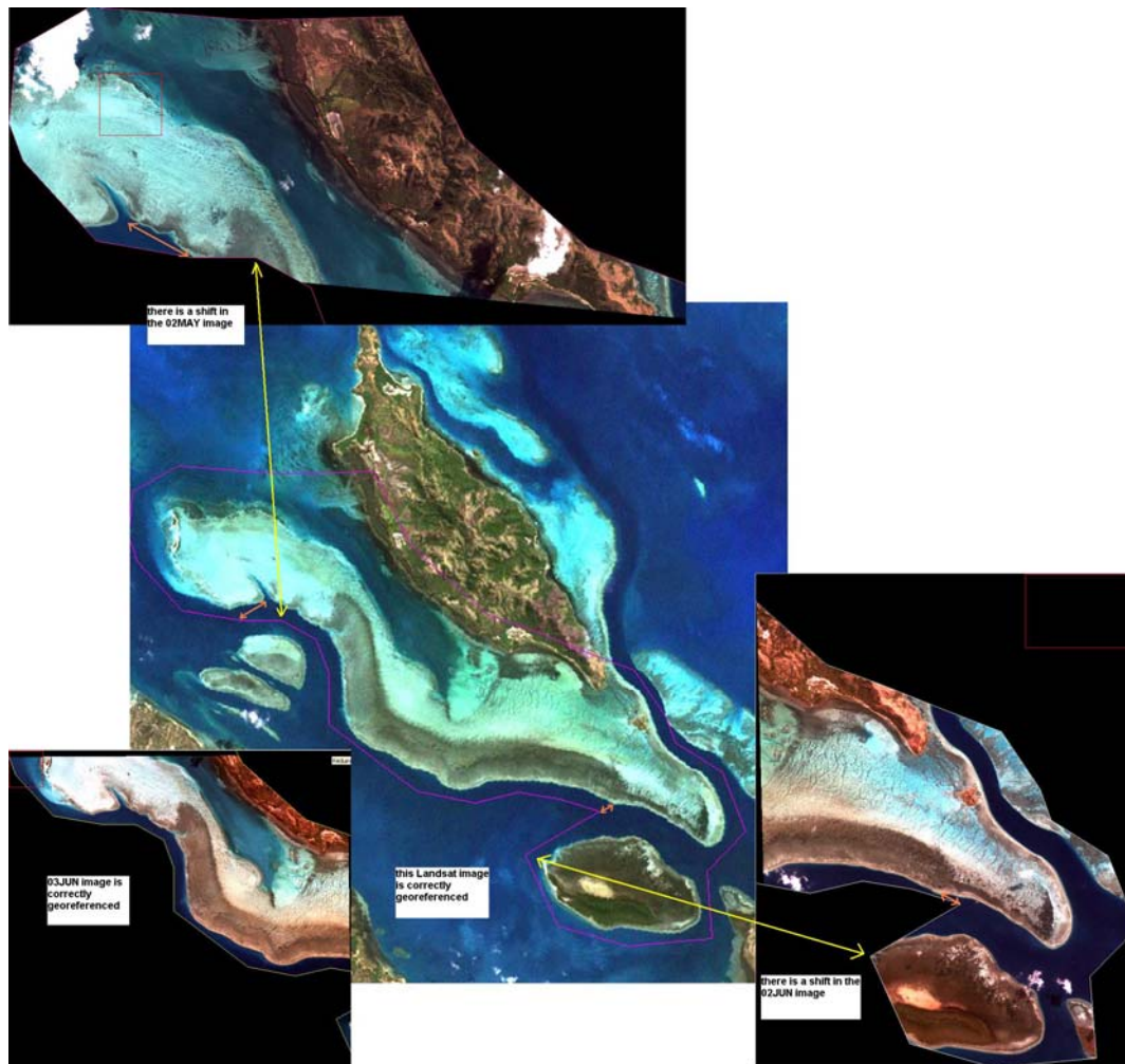
Figure 2 : Comparaisons des trois images QB avec une image Landsat7 sur laquelle la zone commandée est visualisée par un polygone violet: deux des images QB fournies présentent un problème de troncature (mis en évidence par les flèches) dû à un problème de calibration des informations de géoréférencement.
