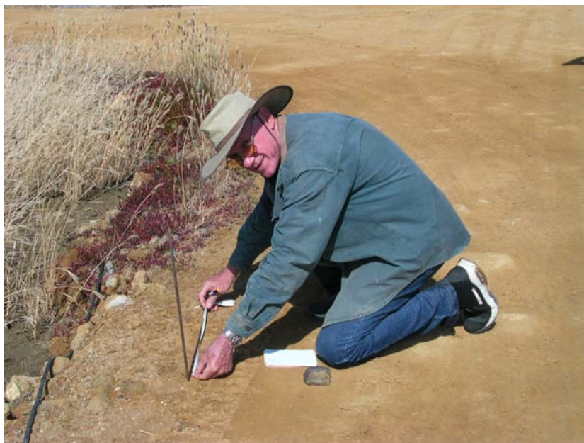
Figure 6 : Mesure de l'angle solaire avec le zénith.
