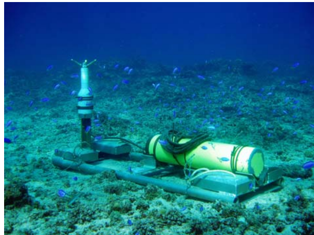
Figure II-10 La sonde Sontek ADVOcean en opération
