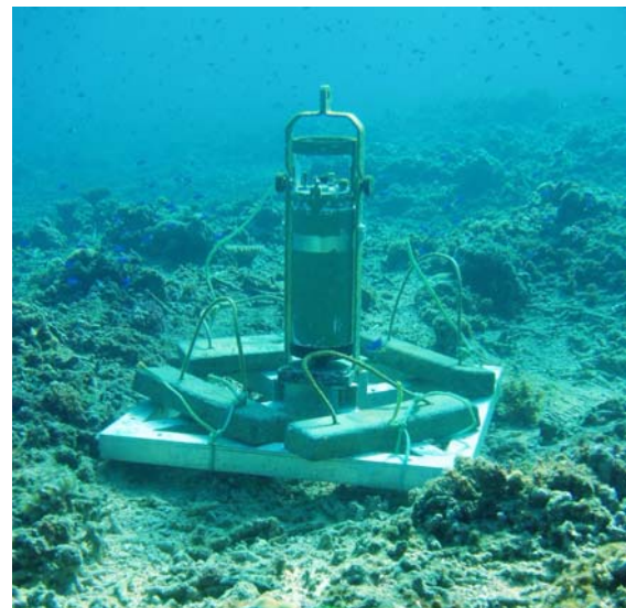
Figure II-8 Le houlom tre Aanderaa WTR9 en op ration
