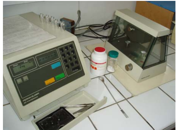
Figure II-4 Perkin-Elmer AD-4 Autobalance: précision de 0.001 mg.
