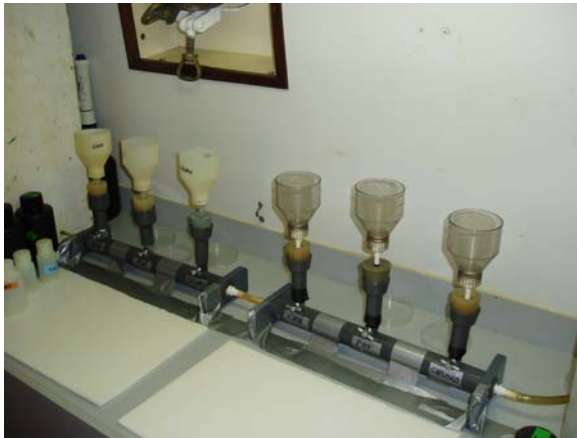
Figure II-3 Rampe de filtration: la dépression est contrôlée et se fait par effet Venturi.
