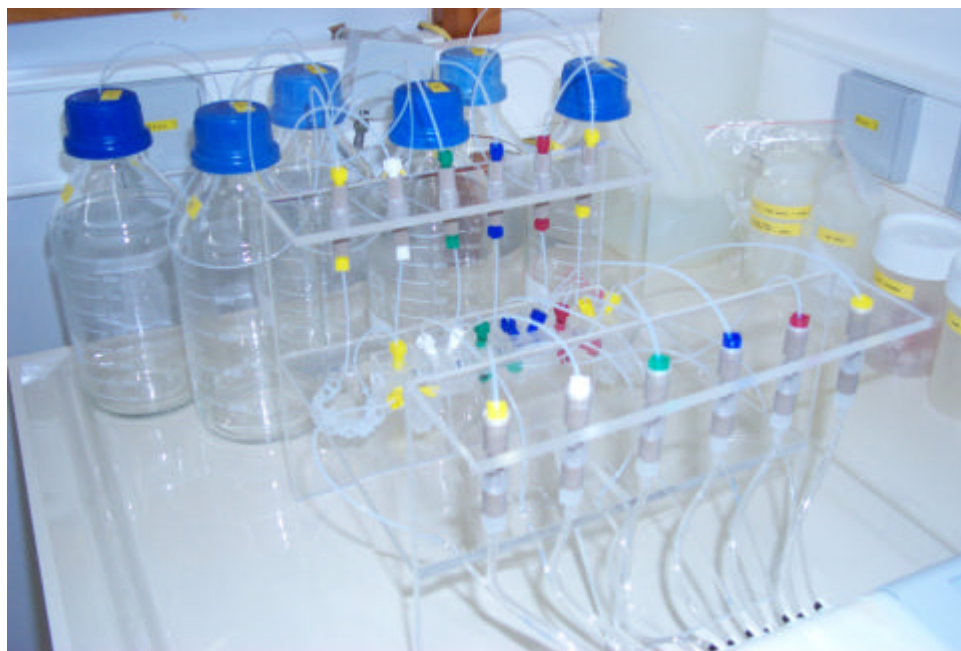
Figure.2. Chaque voie est désignée par une couleur pour faciliter l'utilisation du banc.
