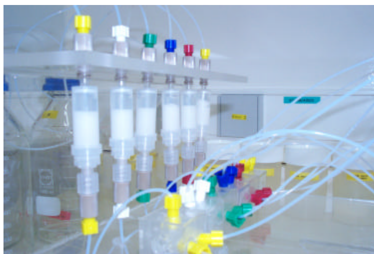
Figure.6. Images montrant les colonnes connectées dans le banc de percolation.
