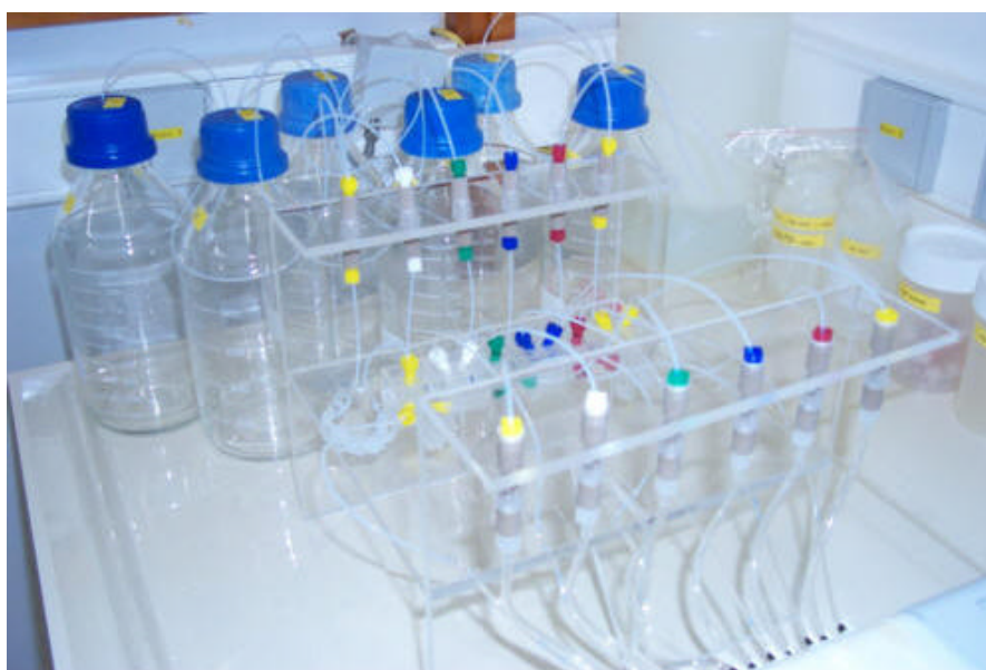
Figure.10. Vue des 6 lignes du banc de percolation dans sa configuration en mode « Ajustement du pH en ligne ».
