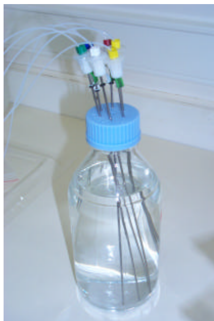
Figure.3. Bouteille de rinçage avec les 6 aiguilles d'échantillonnage
