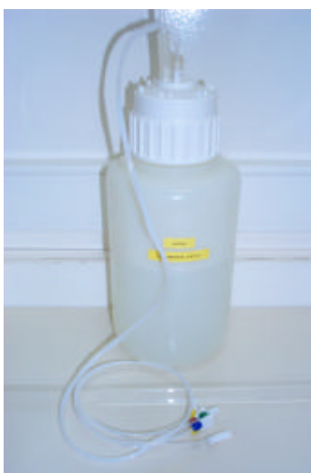
Figure.8. Bouteille de 4 litres équipée d'un filtre à air pour le stockage du tampon.
