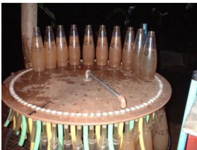
Photographie 4. Prélèvements réalisés par préleveur automatique en période de crue – Fréquence 3 minutes (J.P. Bricquet)
