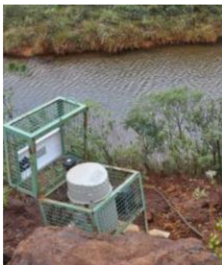
Photographie 3. Préleveurs ISCO site de Vale NC (Asconit – N. Bargier 2014)
