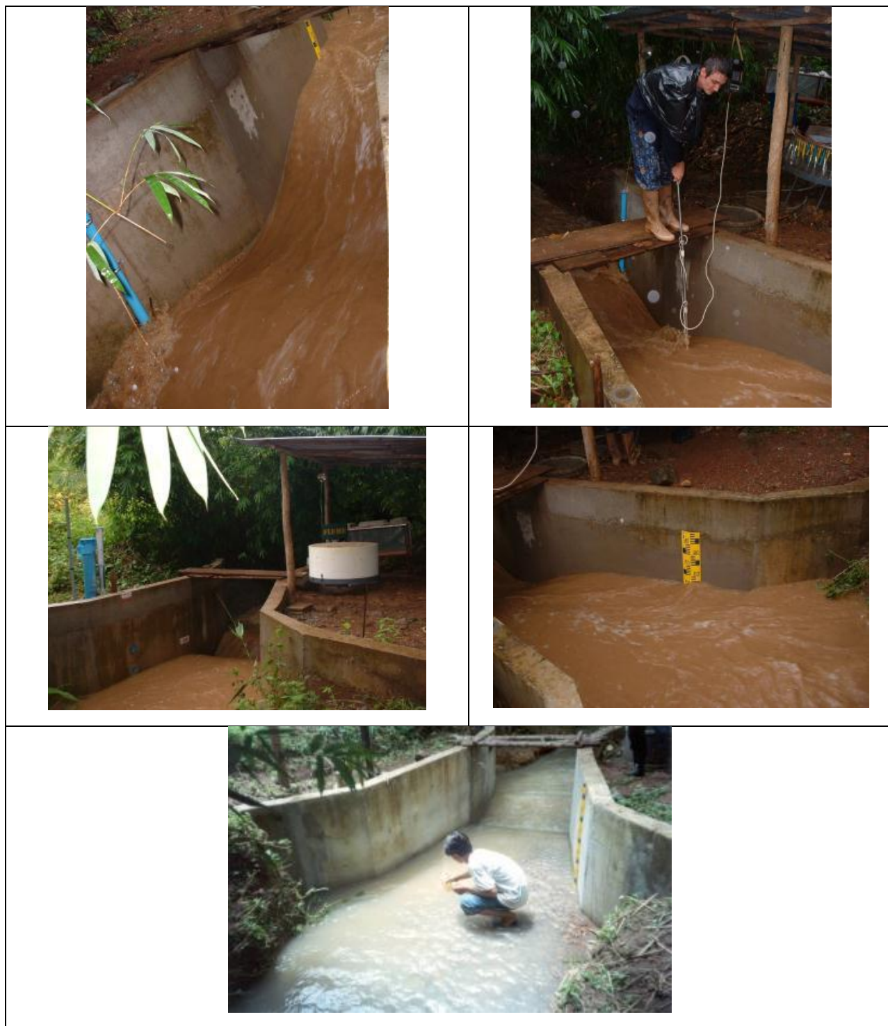
Photographie 2. Dispositifs Parshall et matériels de mesure associés.
