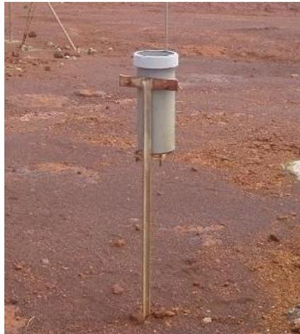
**Figure 3 : Dispositif de collecte des eaux de pluie**
