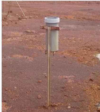
Figure 2 : Dispositif de collecte des eaux de pluie
