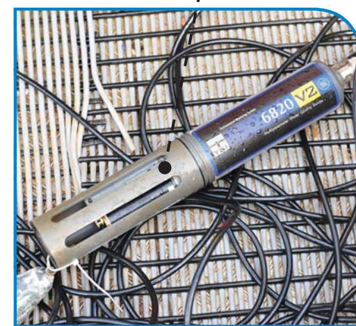
Sonde permettant d'analyser l'eau
