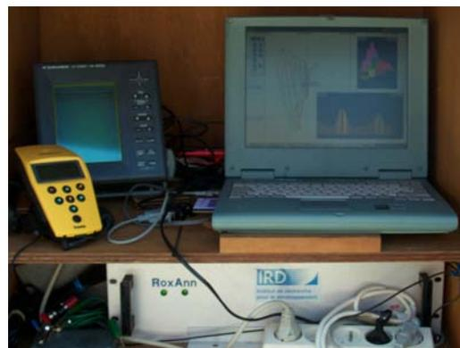
Fig. 2. Image des éléments du système. (GPS, sondeur, micro-ordinateur et boîtier classificateur RoxAnn).
