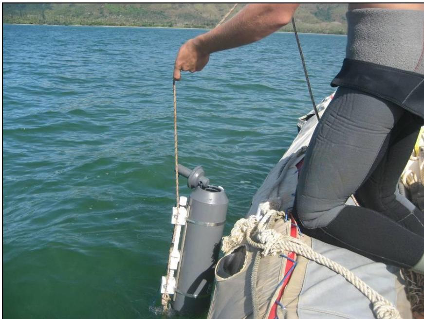
*Figure n°12 : Echantillonneur 5 litres pour les prélèvements d'eau.*
