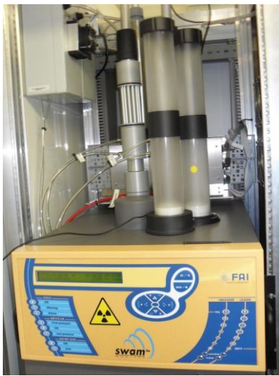
Figure 3 : le SWAM-FAI équipant le laboratoire mobile
