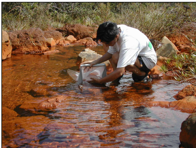
Echantillonnage au filet « Surber »
