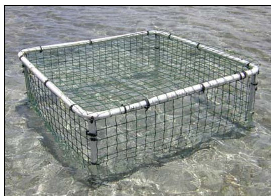
Fig.10 Exclos d'étude grillagé, 1x1x0,5m, fixé sur l'herbier de N'Gouja
