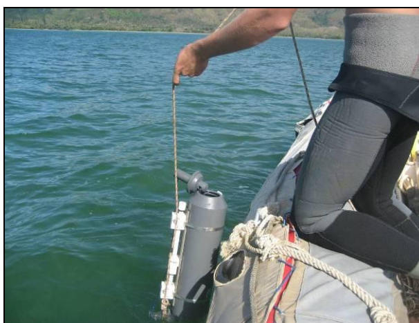
Figure 9 : Echantillonneur 5 litres pour les prélèvements d'eau
