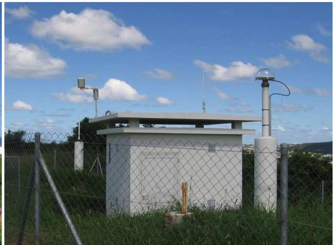
La zone Ouest étant masquée, la base différentielle de la SARL a été installée sur les hauteurs de la rue de Papeete, ou à l'angle Nord du dépôt de scorie. La station de base Trimble 4000 SSI diffusait ses corrections de phases sur la fréquence 444.1125 MHz.
