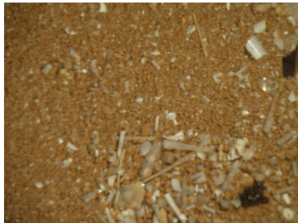
Figure 4 : Observations au microscope optique des fractions \varnothing > 40 \mu\text{m} des horizons de surface (0-1 cm, photo de gauche) et du bas de la carotte St16 (9-10 cm, photo de droite) dans laquelle la proportion de débris carbonatés issus des micro-organismes marins est supérieure. Grossissement x 11,5.
