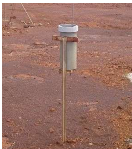
Figure 2 : Dispositif de collecte des eaux de pluie
