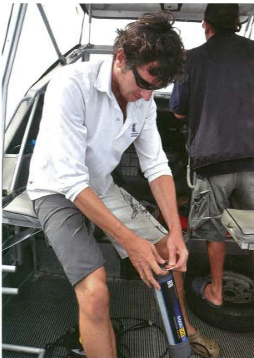
Mission de terrain suite à l'incident survenu sur l'émissaire marin. Une sonde mesurant plusieurs paramètres simultanément a été testée et immergée en 7 points autour du diffuseur.
