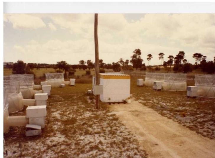
Dispositif technique montrant les tunnels vertical et maisonnette contenant les appareils de dosage de gas  $\text{SO}_2$  et détecteurs (Australie Occidentale).
