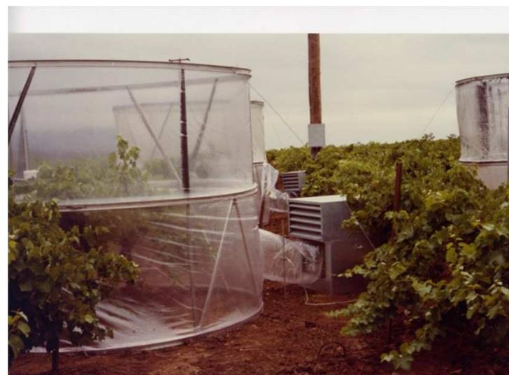
Dispositif de la tonnelle montrant system ventilation et alimentation en  $\text{SO}_2$ .
